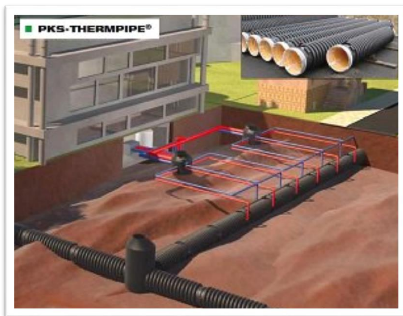
Obr. (5), schéma využití systému PKS Thermpipe pro vytápění objektu
