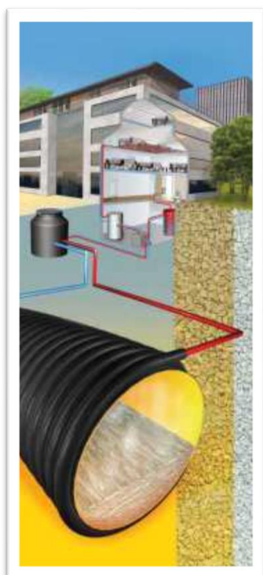
Obr. (6), schéma využití systému PKS Thermpipe pro vytápění objektu
